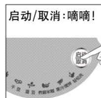
轻触“选择”键选择对应的功能，每次选择后，仅对应功能指示灯（或图形指示灯）亮并闪烁，并伴有“嗒”一声提示音，轻触“启动/取消”键启动功能，机器伴有“嗒嘀”提示音提示已启动。
